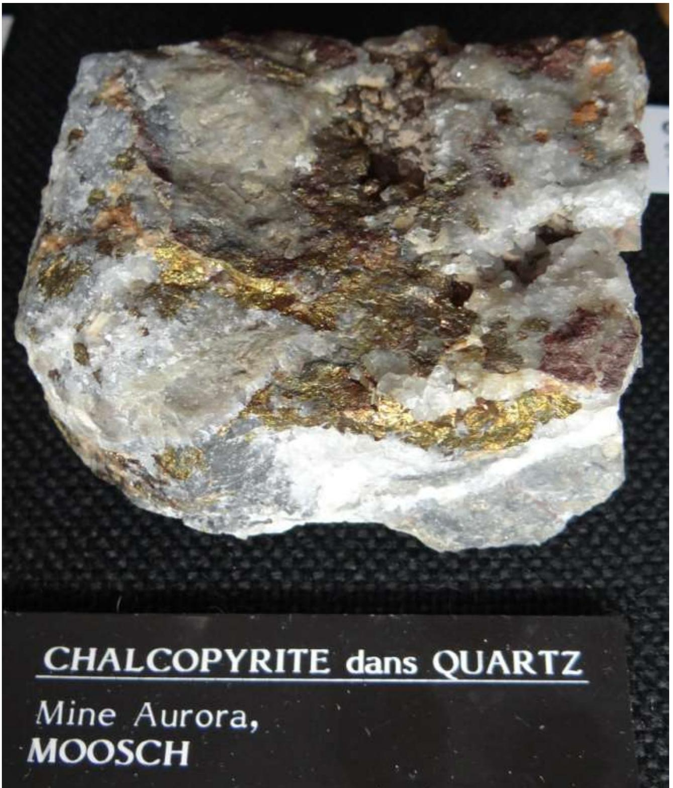
**CHALCOPYRITE** dans **QUARTZ** – Mine Aurora « Mine d'Argent » à MOOSCH
